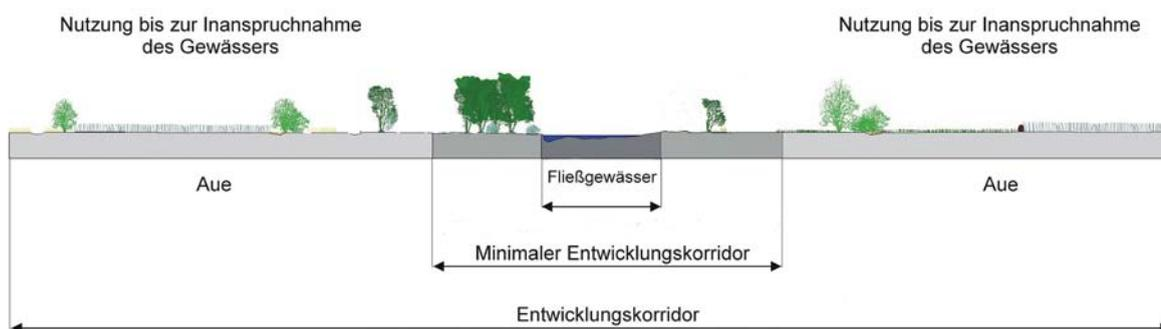
Abb. A.2: Schematische Darstellung zur Lage und Ausdehnung des Entwicklungskorridors
