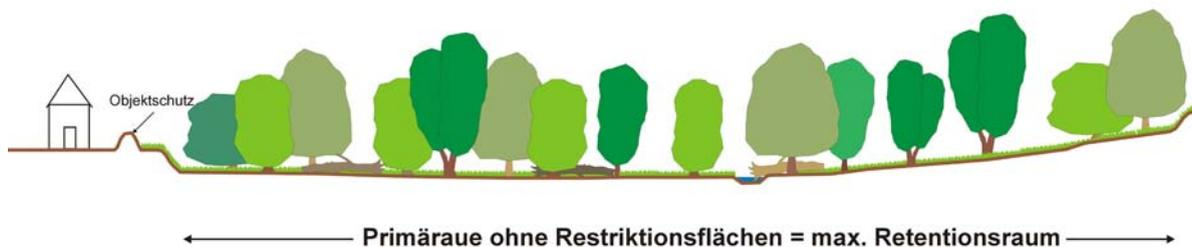
Abb. 100: Schematische Darstellung der Reaktivierung einer Primäraue (Quelle: PLANUNGSBÜRO KOENZEN 2010)
