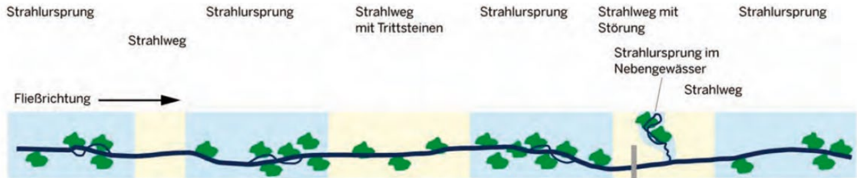
Abbildung 2: Schematische Darstellung der Funktionselemente des Strahlwirkungs- und Trittsteinkonzeptes (nach DRL 2008)
